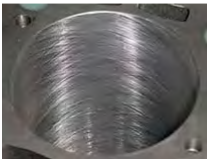
Beispiel für den beim Honen entstehenden Kreuzschliff.
