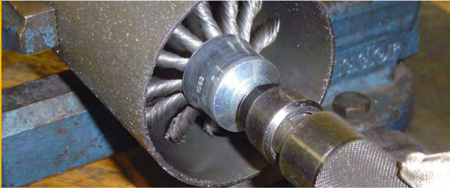
Öffnung der Pinselfürsten in Abhängigkeit von der Drehzahl
