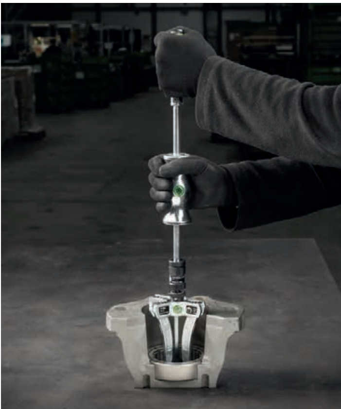
3-armiger Innenauszieher (114-2) mit Gleithammer beim Ausziehen eines Zylinderrollenlagers aus einem Gehäuse
