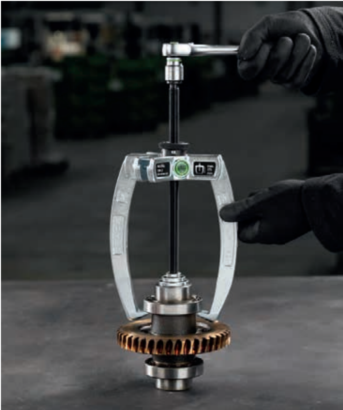
2-armiger Kombi-Abzieher (114-3) beim Außenabziehen eines Kugellagers am Getriebeteil
