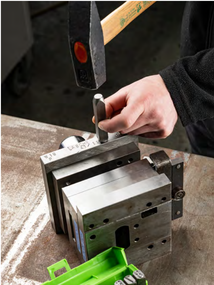
Markieren eines Stanzwerkzeugs mit Schlagzahlen der Baureihe 328
