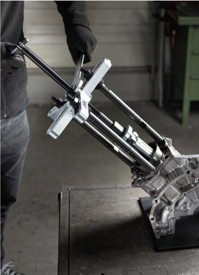
Mit drei Fußbolzen an der Multitraverse hat man einen optimalen Stand beim Ausziehvorgang mit dem Zylinderbuchsenauszieher 16-2
