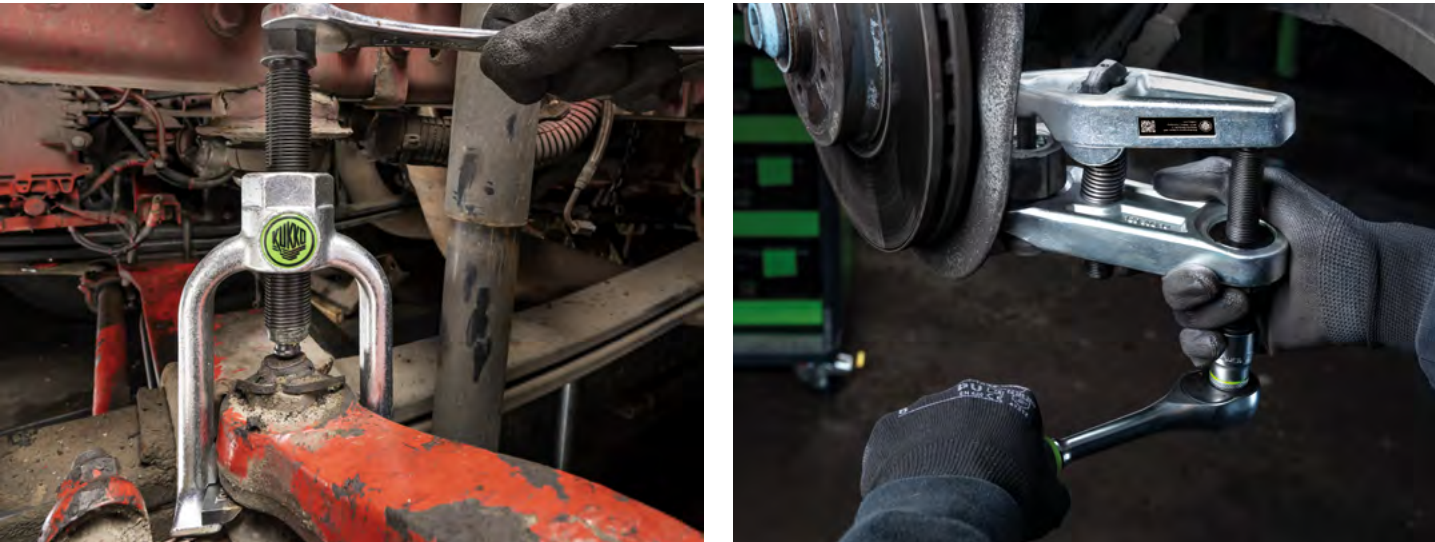
Der Kugelgelenkabzieher 128-60 beim Ausdrücken eines Spurstangenkopfes an einer Spurstange
