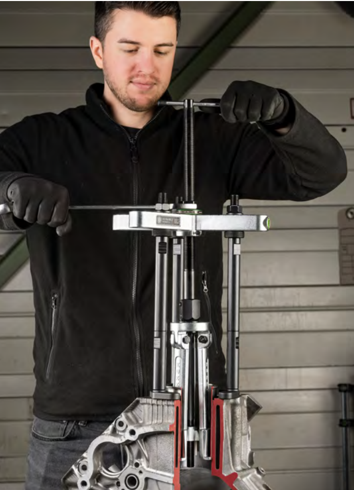
Ein Blick ins Innere beim Ausziehen einer Zylinderbuchse
