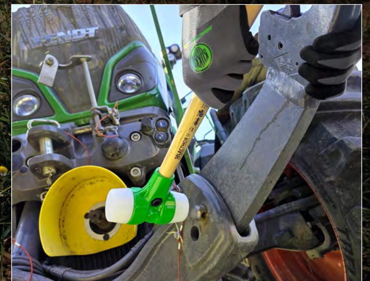
Ausschlagen eines Bolzens an der Geräteaufnahme eines Traktors
