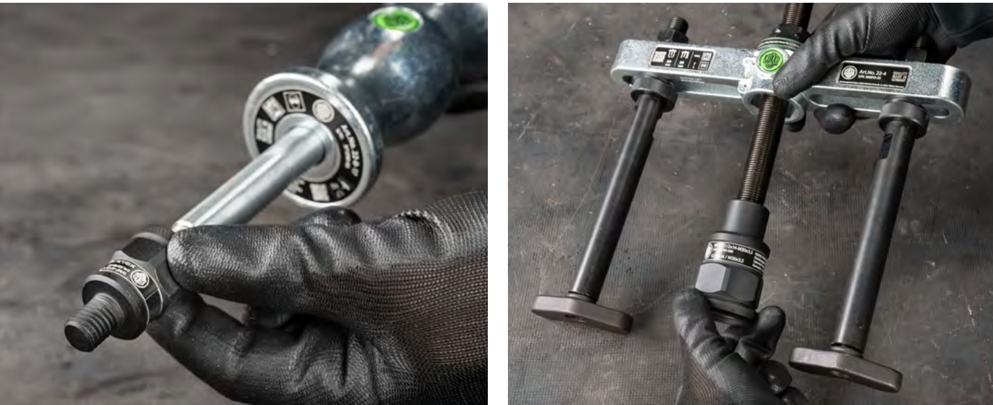
Durch die Verbindung eines Gewindeadapters mit einem Gleithammer (Baureihe 22-0+) kann ein Bauteil mit Innengewinde unter hoher Zugkraft besonders schonend ausgezogen werden. Ein Gewindeadapter wird mit einer Gegenstütze (Baureihe 22) kombiniert, um einen Bolzen mit Außengewinde zu demontieren.
